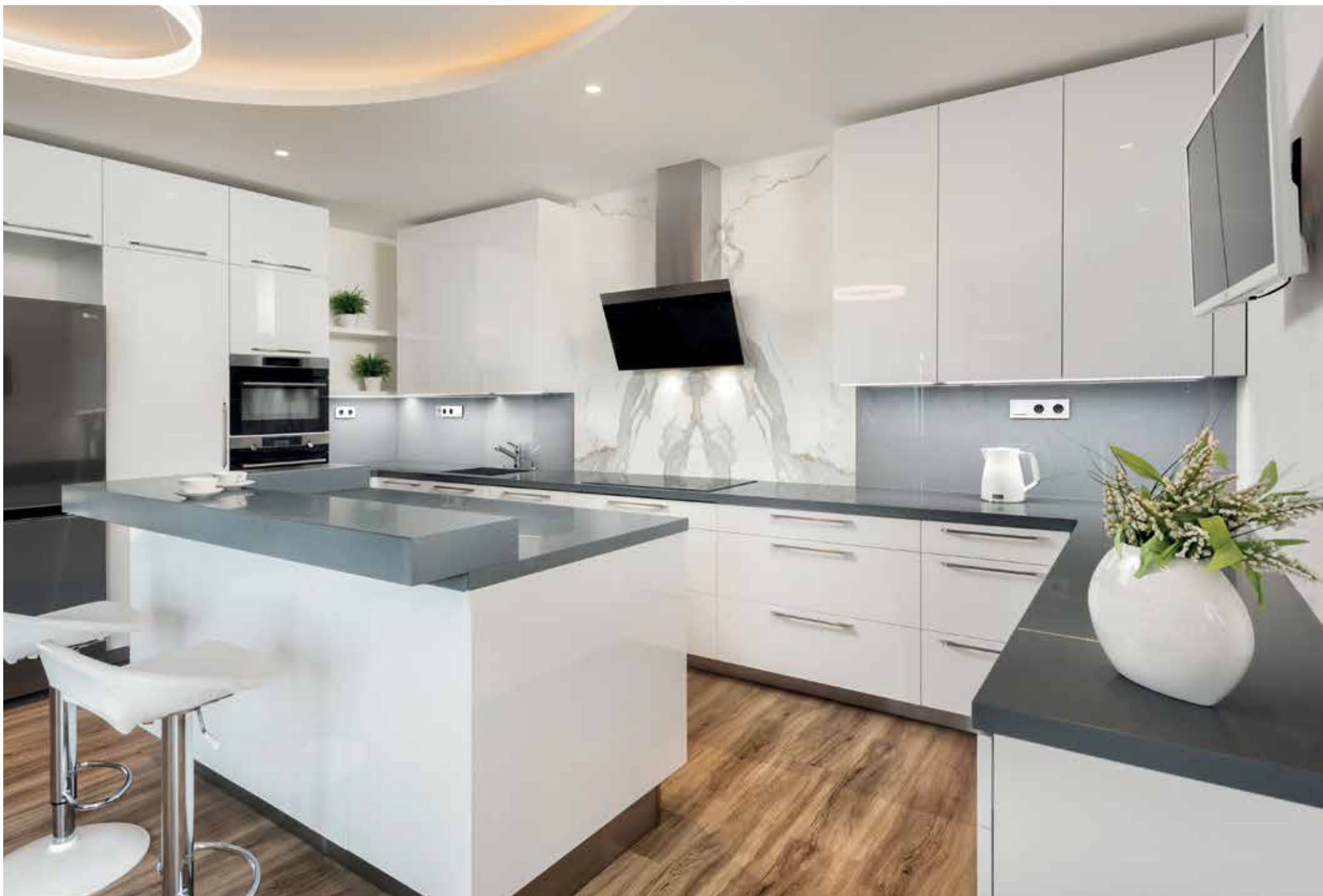
Kuchynská pracovná doska s atypickým barovým pultom z umelého kameňa Polyston vo vzore 1227 Antracit a keramickým obkladom.
